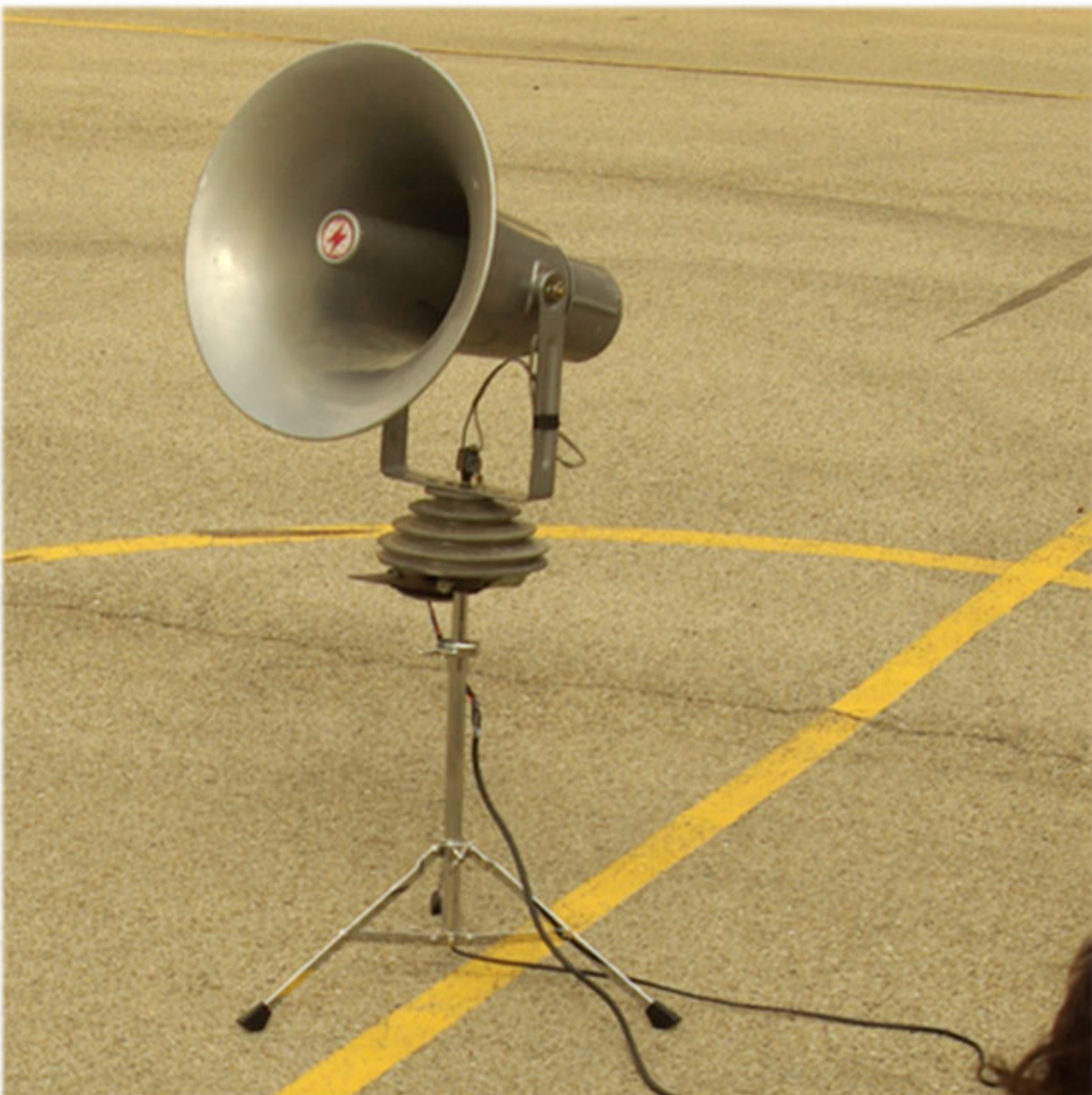
La trompette : dispositif d'exterieur, généralement placé en début de rencontre, c'est un générateur d'échos tournant à 360 degres
